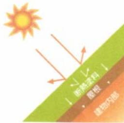
太陽光からの熱を塗膜に蓄め込む、いわゆる断熱材の発想です。この理論ですと徐々に塗膜の温度が上昇し、また、冷めにくく、夜間に放熱をしますので、ヒートアイランド対策には十分ではありません。
